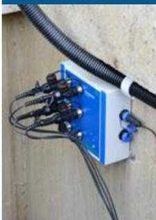
Das Global Data Transmitter Multiple (GDT-M) ist ein Telemetriesystem, an das bis zu 6 Sensoren angeschlossen werden können.
