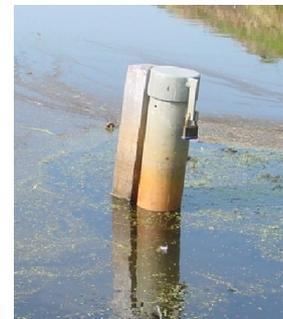
Wenn ein Stahlrohr, in dem eine 1" Grundwassermessstelle installiert ist, verwendet wird (s. Abbildungen), sollte der Endpunkt des Diver etwas über das Rohr hinausragen, damit die Sensoren des Diver auch an dieser Stelle mit Wasser in Kontakt kommen.
